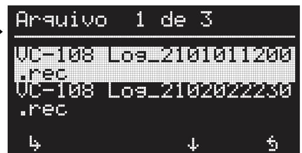
Em seguida, selecione a receita desejada na lista exibida pelo controlador utilizando as teclas **UP** e **DOWN**, e pressione a tecla **SET**.
