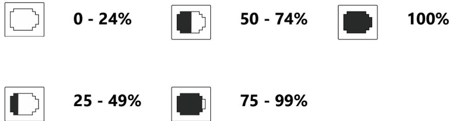
Quando o equipamento está desconectado da rede elétrica, o ícone da carga representa exatamente o valor descrito na tabela, e um símbolo de bateria estacionária é exibido na Barra de Status. Quando o equipamento está conectado à rede elétrica, o ícone de carga é uma animação, alternando sequencialmente entre os níveis da tabela, e um símbolo de plugue de tomada é exibido na Barra de Status.
