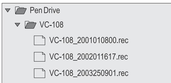
Assim como é possível exportar uma receita contendo os parâmetros do controlador, é possível importar uma receita exportada de outro controlador ou criada através do gerador de receitas do **SitradPRO**. O arquivo de receita com a extensão **.rec** deve ser colocado dentro de um diretório chamado **VC-108** localizado na raiz do sistema de arquivos do *pen drive*.
