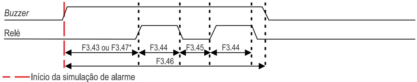
Quando a função F3.46 está configurada em 9 (Off), a simulação do alarme tem a duração de 10 segundos, e o relé de alarme/discadora **não é acionado**.
