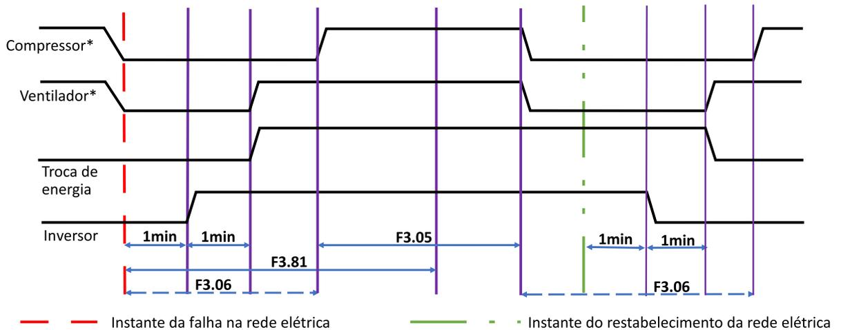
Exemplo de falta de energia por período inferior ao configurado em F3.81
