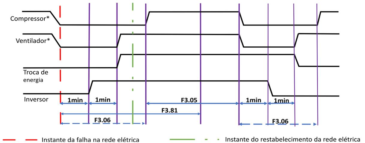
No gráfico, o acionamento dos relés Compressor e Ventilador indicam que o controle do processo tem permissão para acionar essas saídas. Caso a tensão DC esteja fora dos limites ajustados em F3.48 (Tensão DC mínima de alimentação do controlador) e F3.49 (Tensão DC máxima de alimentação do controlador) por um período fixo de 5 segundos, serão desligadas todas as saídas, inclusive a saída do inversor, permanecendo somente a saída Troca de Energia. O equipamento ficará
