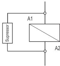
A1 e A2 são os bornes da bobina da contadora.
