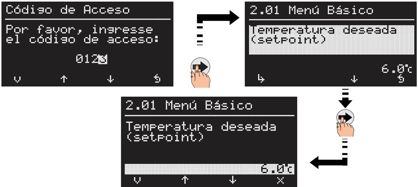
Para cambiar entre parámetros, utilice las teclas **UP** y **DOWN**. Seleccione el parámetro deseado para editar con la tecla **SET**.
