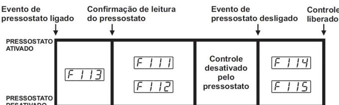
**Nota 1:** Ao terceiro evento de pressão alta ou baixa, no intervalo máximo de uma hora ao inicializar o controlador, o sistema exibe a mensagem **[RPLn]** - Alarme de pressostato de baixa, do qual requer que o sistema seja rearmado manualmente. Para isso, acesse o menu rápido, via tecla **[R]**, selecione **[HPLP]** e pressione com toque curto a tecla **[M]** para selecionar.
