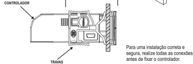
Para uma instalação correta e segura, realize todas as conexões antes de fixar o controlador.
