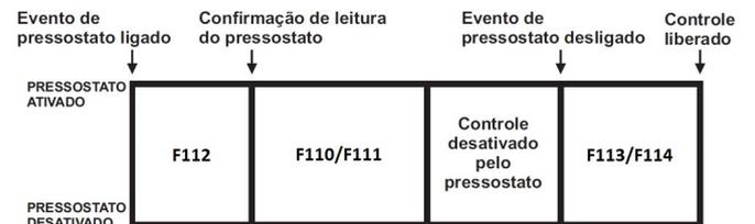
**Nota 1:** Ao terceiro evento de pressão alta ou baixa, no intervalo máximo de uma hora ao inicializar o controlador, o sistema exibe a mensagem [RPLD] - Alarme de pressostato de baixa, do qual requer que o sistema seja rearmado manualmente. Para isso, acesse o menu rápido, via tecla **Q**, selecione [RPLP] e pressione com toque curto a tecla **↵** para selecionar.
