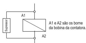
Esquema de ligação de supressores em cargas acionamento direto
