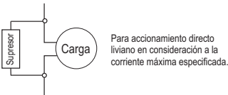
Esquema de conexión de supresores en cargas de accionamiento directo
