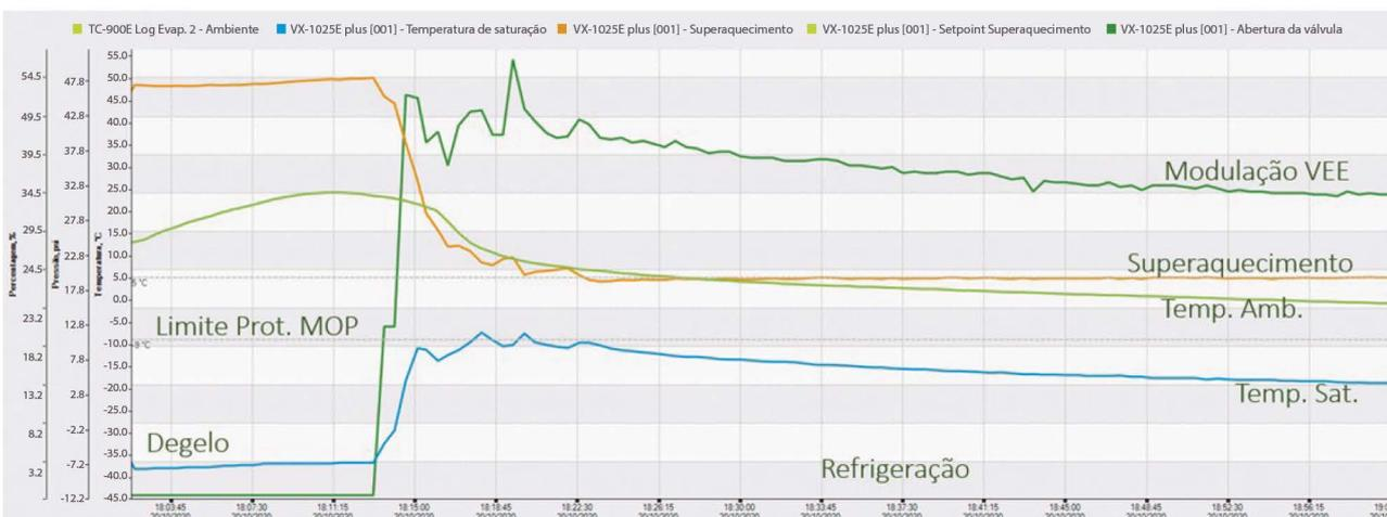
A figura abaixo ilustra a execução da proteção de superaquecimento baixo (LoSH). Observe que quando o superaquecimento diminui e alcança 4°C, a válvula é fechada com maior intensidade, reduzindo a quantidade de fluido e elevando o superaquecimento ao seu valor de ajuste, no caso 8°C.
