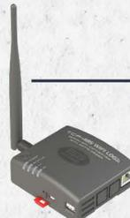
Realiza a comunicação entre os controladores com o Sitrad PRO através de uma rede de dados WiFi, usando o padrão de comunicação TCP/IP. Possui memória interna (datalogger) para armazenamento dos dados. A TCP-485 WiFi Log dispensa o uso de cabeamento ethernet para gerenciamento das instalações.
