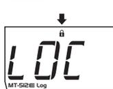
Para desbloquear, desligue o controlador e volte a ligá-lo com a tecla **F** pressionada. Mantenha a tecla pressionada até que a mensagem **LOC** apareça. Ao soltar, a mensagem **Off** será exibida no display.
