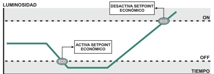
➔ **NOTA:** Incluso con el sensor de luminosidad habilitado las demás formas de activación/desactivación del setpoint económico conforme lo descrito en el ítem 6.3.4 continúan funcionando.
