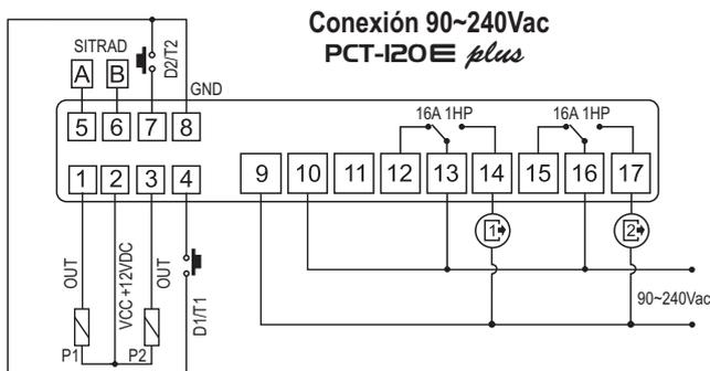
Conexión eléctrica de los sensores de temperatura/entradas digitales:
