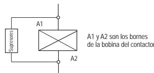
Esquema de conexión de supresores en cargas de activación directa
