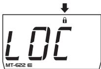
Para desbloquear, apague el controlador y vuelva a prenderlo con la tecla [ ] oprimida. Mantenga la tecla oprimida hasta que aparezca el mensaje [L O C ]. Tras soltarla, el mensaje [O F F ] será exhibido en la pantalla.
