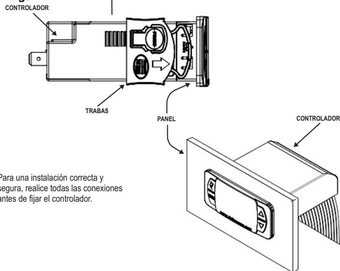
Para una instalación correcta y segura, realice todas las conexiones antes de fijar el controlador.
