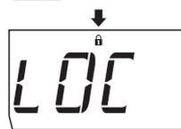
Para desbloquear, desconecte el controlador y vuelva a conectarlo con la tecla **FLATEC** presionada. Mantenga la tecla presionada hasta que el mensaje **LOC** aparezca. Al soltarla, el mensaje **FFF** será exhibido en el display.
