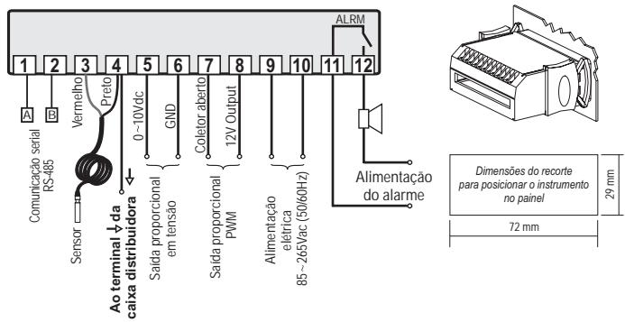
Para corrente superior à especificada deve-se usar contadora para acionar o alarme.
