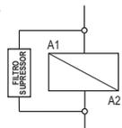
Esquema de ligação de supressores em cargas com acionamento direto
