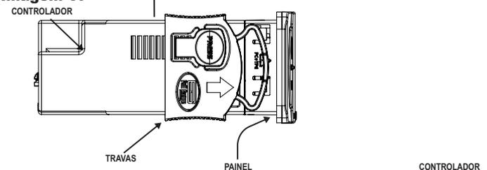
Para uma instalação correta e segura, realize todas as conexões antes de fixar o controlador.
