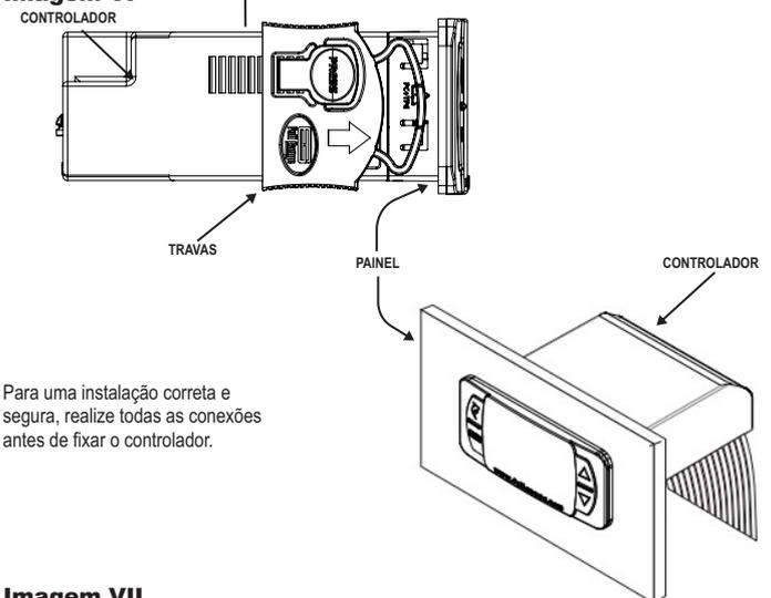
Para uma instalação correta e segura, realize todas as conexões antes de fixar o controlador.
