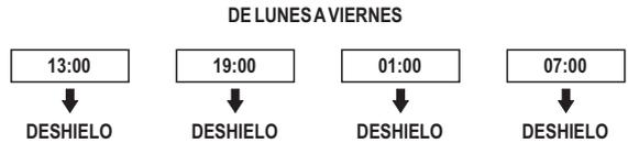
**Nota:** Si la condición para inicio de deshielo está configurada para agenda de deshielos y el reloj está desconfigurado o deshabilitado, el inicio de deshielos de dará por tiempo.
