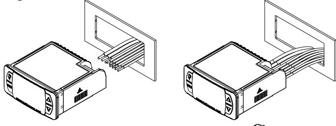
Para uma instalação correta e segura, realize todas as conexões antes de fixar o controlador.
