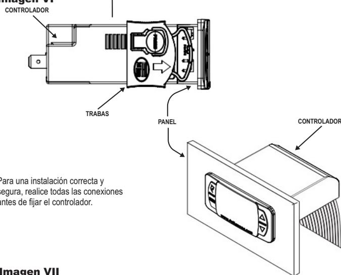
Para una instalación correcta y segura, realice todas las conexiones antes de fijar el controlador.
