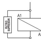
Esquema de conexión de supresores en cargas con accionamiento directo
