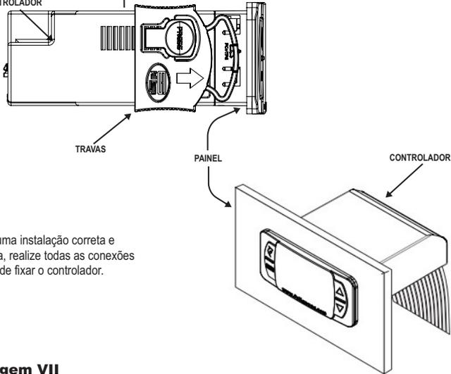
Para uma instalação correta e segura, realize todas as conexões antes de fixar o controlador.
