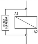
Esquema de conexión de supresores en cargas con accionamiento directo
